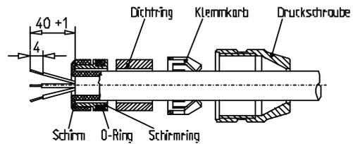
3. Litzen durch Gehäuse fädeln, Schirmring, Dichttring, Klemmkorb montieren, Druckschraube andrehen um das Kabel zu fixieren. Litzen durch die Isolier- bzw. Kodierhülse fädeln und in den Schraubklemmen befestigen.
