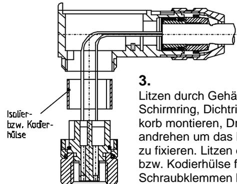
4. Übrige Teile gemäß Darstellung montieren und Druckschraube festdrehen.
